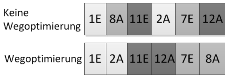
Abbildung 22: Auftragsreihenfolge mit und ohne Wegoptimierung, die vordere Zahl kennzeichnet die Ebene, in der sich der Auftrag befindet, der nachfolgende Buchstabe definiert die Auftragsart. E steht für Einlagerung, A für Auslagerung (in Anlehnung an [38]).
