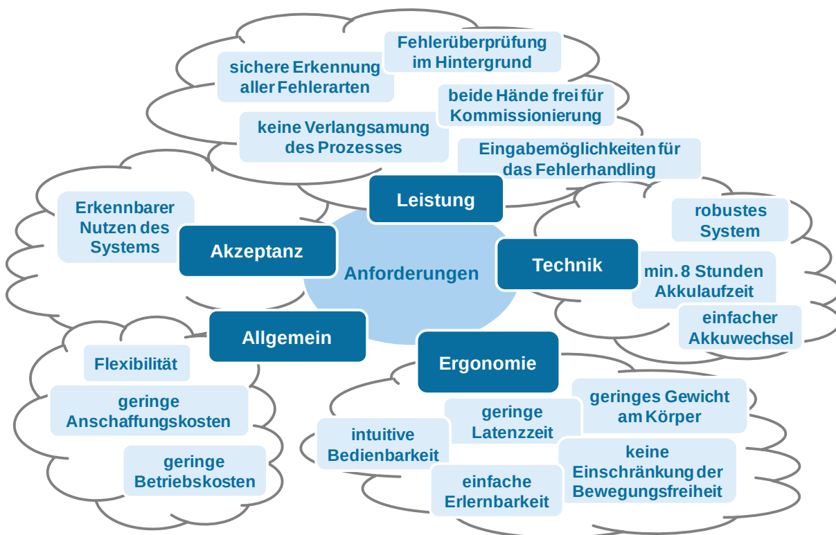
Abbildung 4-1: Übergeordnete Anforderungen an ein fehlersicheres Pick-by-Vision System
